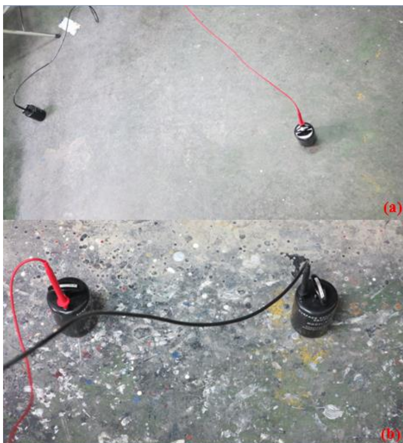
圖 7 調漆室地板電阻量測(a)無油漆滴落；(b)覆蓋油漆之地板
