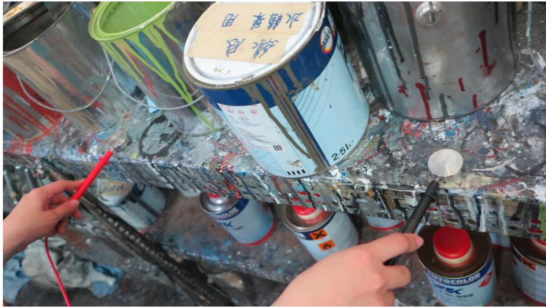
圖 12 試噴區漆台電阻量測
