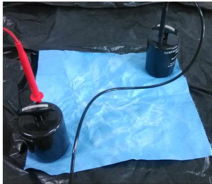
圖 4 擦拭紙電阻量測
