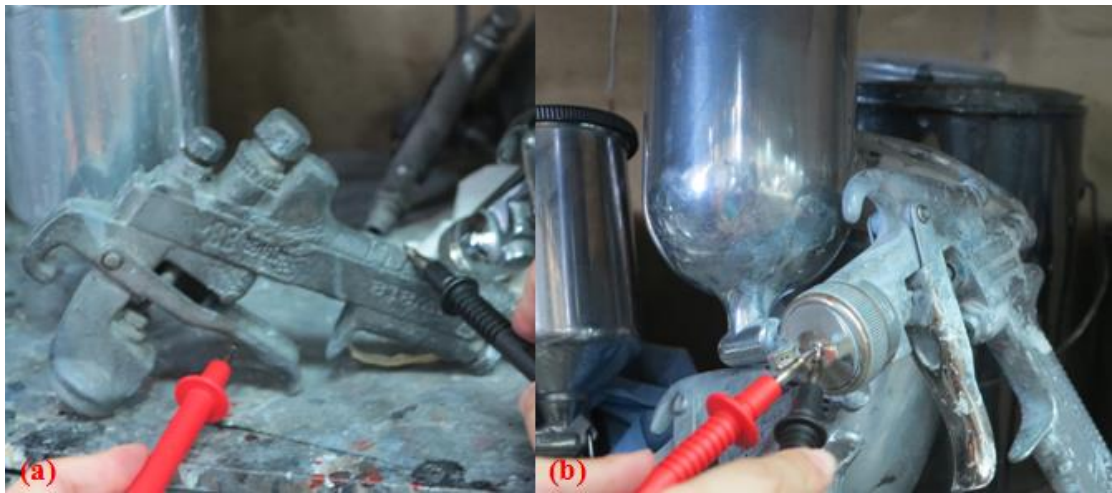
圖 13 噴槍電阻量測
