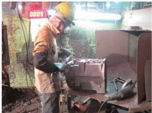
鑄件之研磨加工等後處理作業易發生切割、擦傷危害
