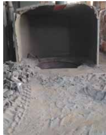
地面粉塵堆積易造成行走滑倒
