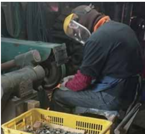
鑄件之研磨加工等後處理作業易發生切割、擦傷危害
