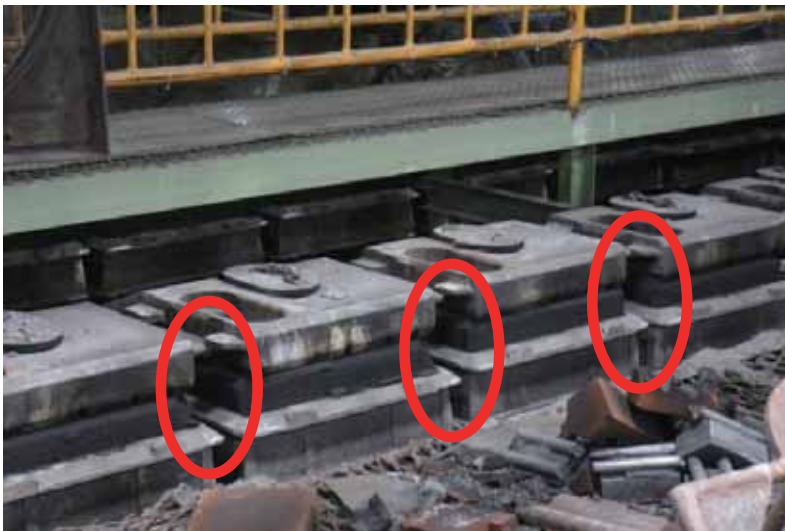
砂模輸送帶運作時，可能造成附近人員被捲
