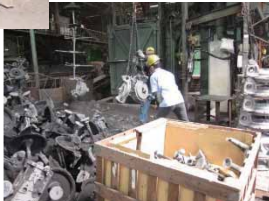
吊掛之鑄件、砂模或餘料敲擊 易發生鑄件迴盪撞傷作業人員
