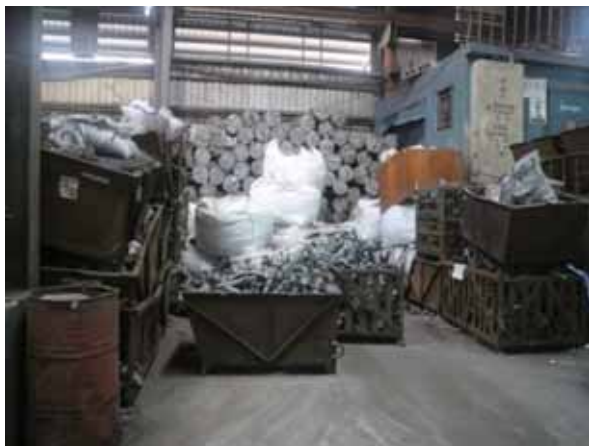
熔煉原料及回爐料等存放區 堆置高度過高
