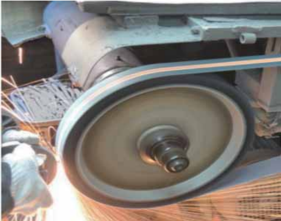
鑄件研磨或切割時因鑄件受力不均易發生鑄件邊緣破裂危害
