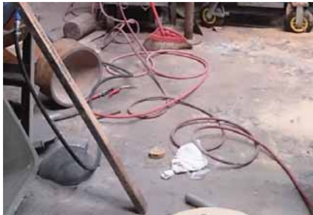
地面電線/空氣管路雜亂，勞工行走時易被絆跌倒
