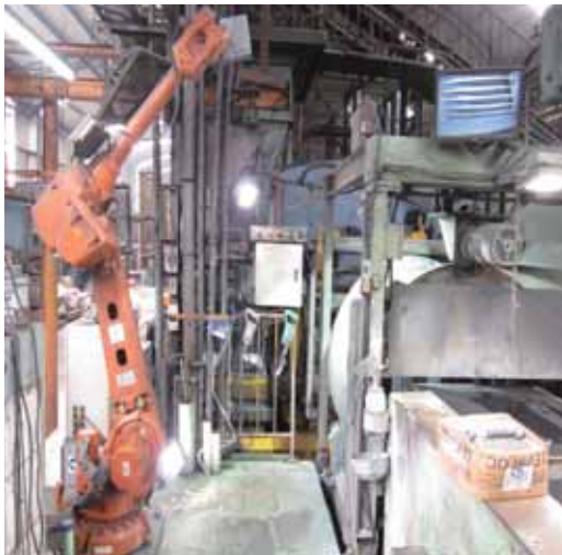
自動造模區人員進入作業範圍 有發生遭機械手臂衝撞危害之虞
