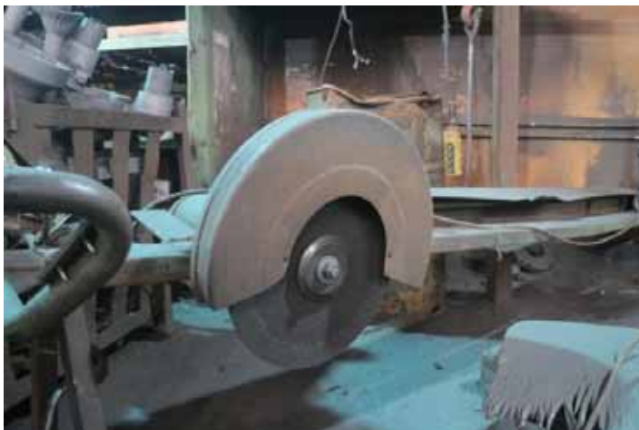
使用切割機從事鑄件毛邊切割作業時, 易發生切割危害
