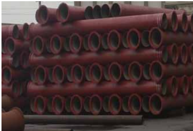
大型圓形鑄件置物易因 重心偏移而造成倒塌危害
